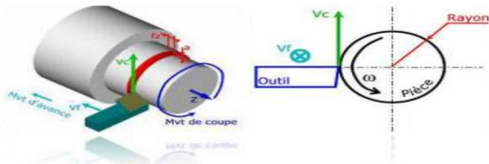
**Figure I.3** les mouvements relatif entre la pièce et l'outil [2]
