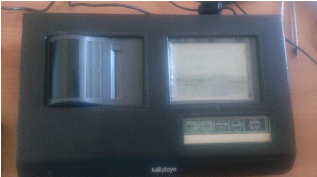
*Figure III.05. Dispositif pour mesurer la rugosité*
