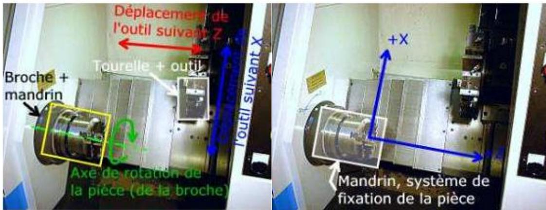
Figure I.13. Présentation des axes de mouvement [3]
