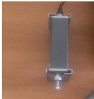
*Figure III.06. palpeur de rugosimètre*
