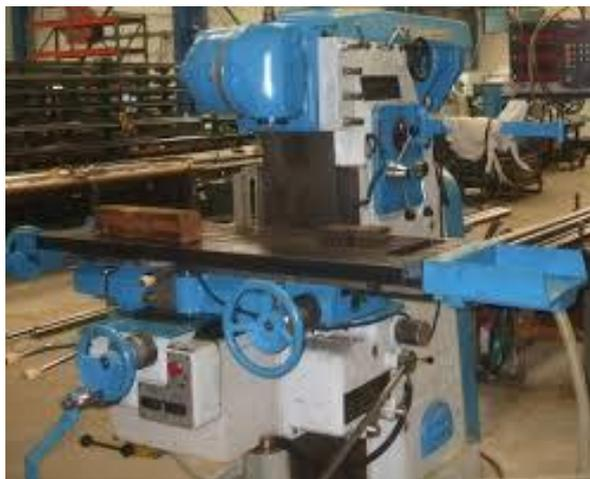
**Figure I.9**Fraiseuse conventionnelle [3]
