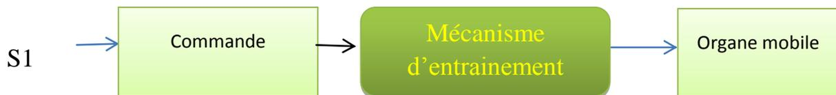
**Fig I.4.** Fonctionnement en boucle ouverte. [6]
