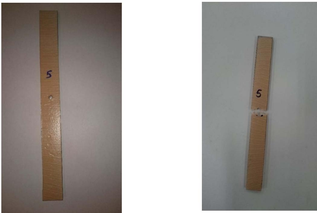
Figure IV.15 : L'éprouvette N°5 avant et après traction
