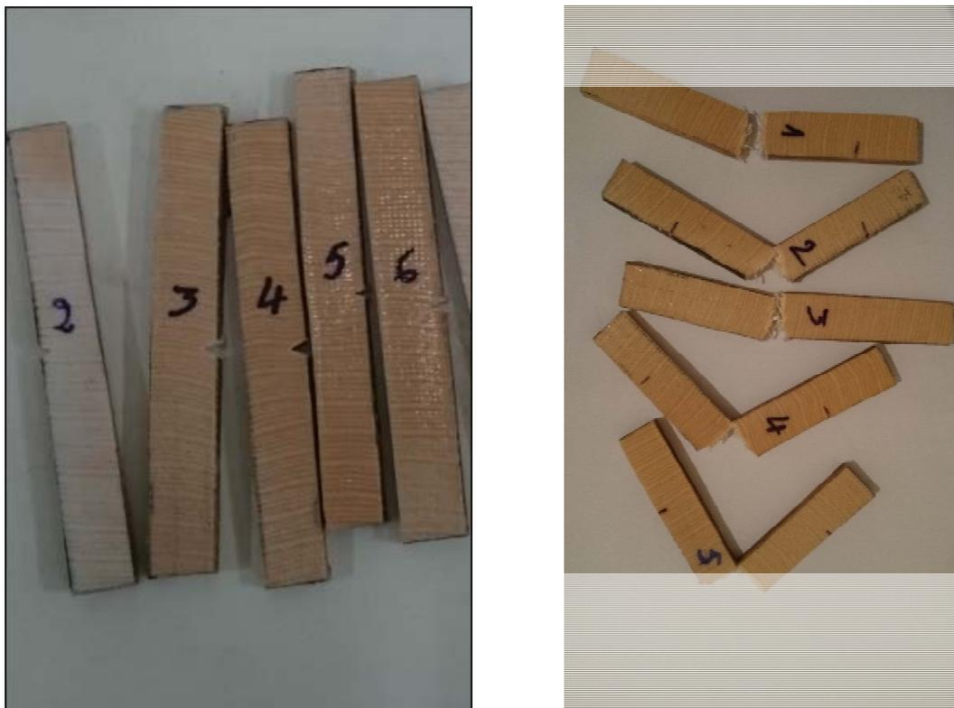
Figure IV.25 : Eprouvettes de choc
