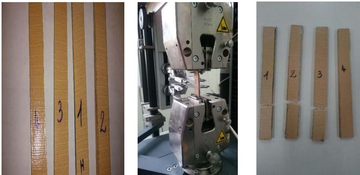
Figure IV.4 : l'éprouvets sans trou en traction
