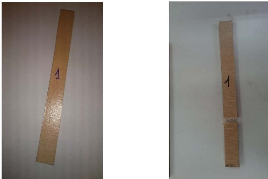
Figure IV.8 : L'éprouvette N°1 avant et après traction
