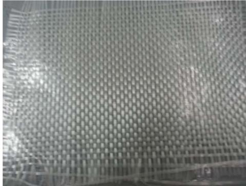
Figure II.7 : Présentation d'un roving
