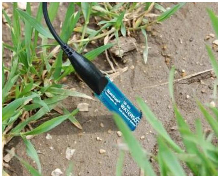
Figure 34 : Capteur d'humidité du sol.
