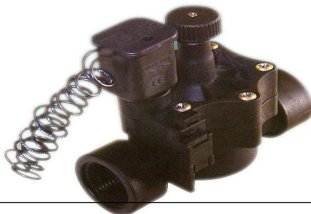
Elle est équipée d'un solénoïde 24 V, 2 connexions étanches et d'un réglage de débit et d'un système marche/arrêt. L'ouverture peut être manuelle par une purge interne.
