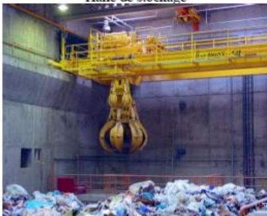
C- Pont roulant avec grappin et palan auxiliaire
