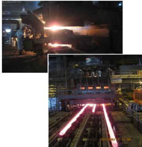
**Figure 8-** Machine a coulée continu.
