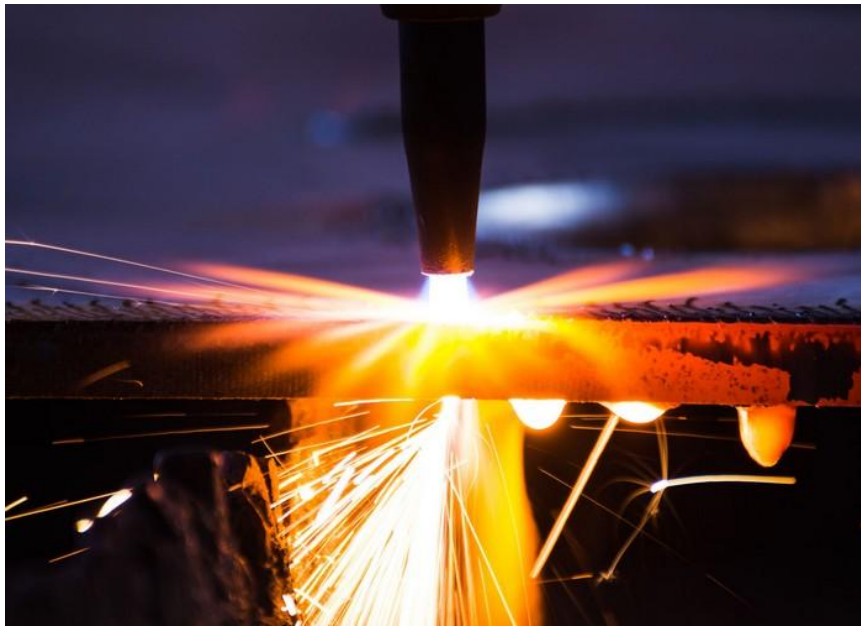
Figure II.1 oxycoupages d'une tôle d'acier
