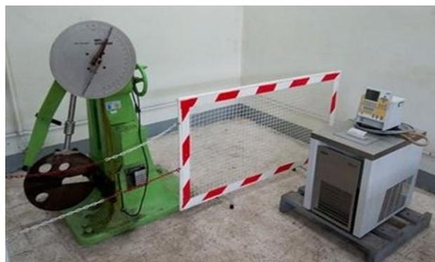
Figure I.22 : Machine de résilience
