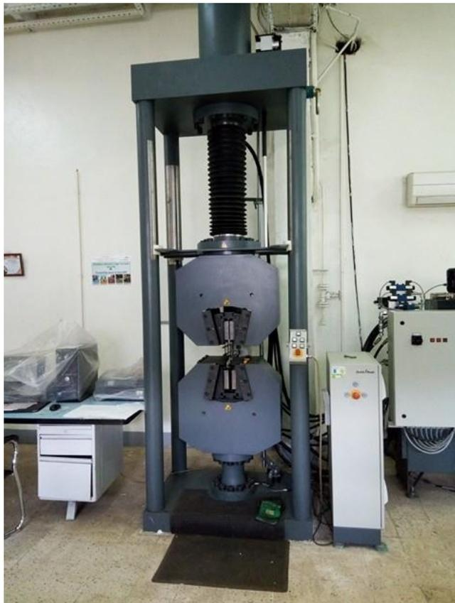
*Figure I.17 : Machine de traction*
