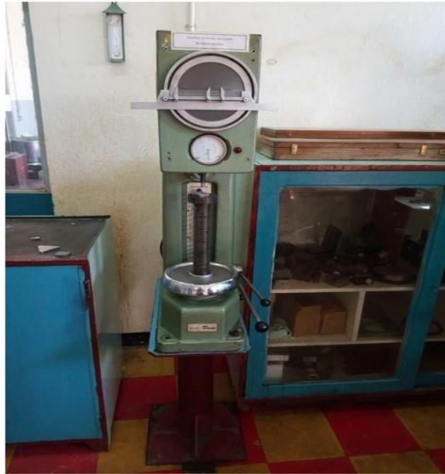
*Figure I.23 : Machine de dureté*
