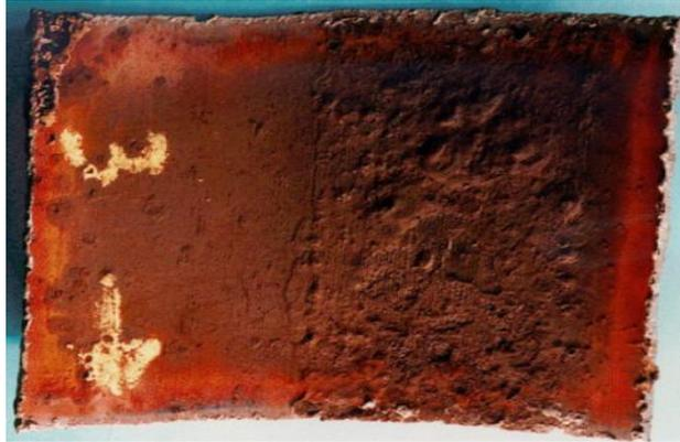
*Figure I.2: Pertes de métal dues à la corrosion interne [1]*
