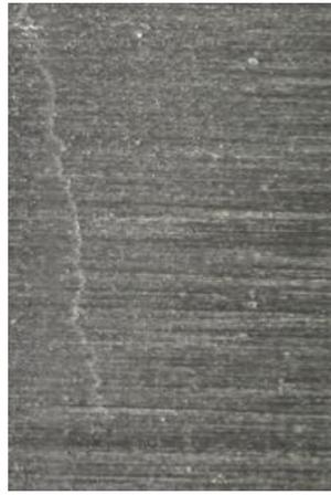
Figure I.7: Visualisation d'une fissure d'ouverture  $20\ \mu\text{m}$  et de longueur 6 mm dans la paroi intérieure d'un tube de faible diamètre [9]
