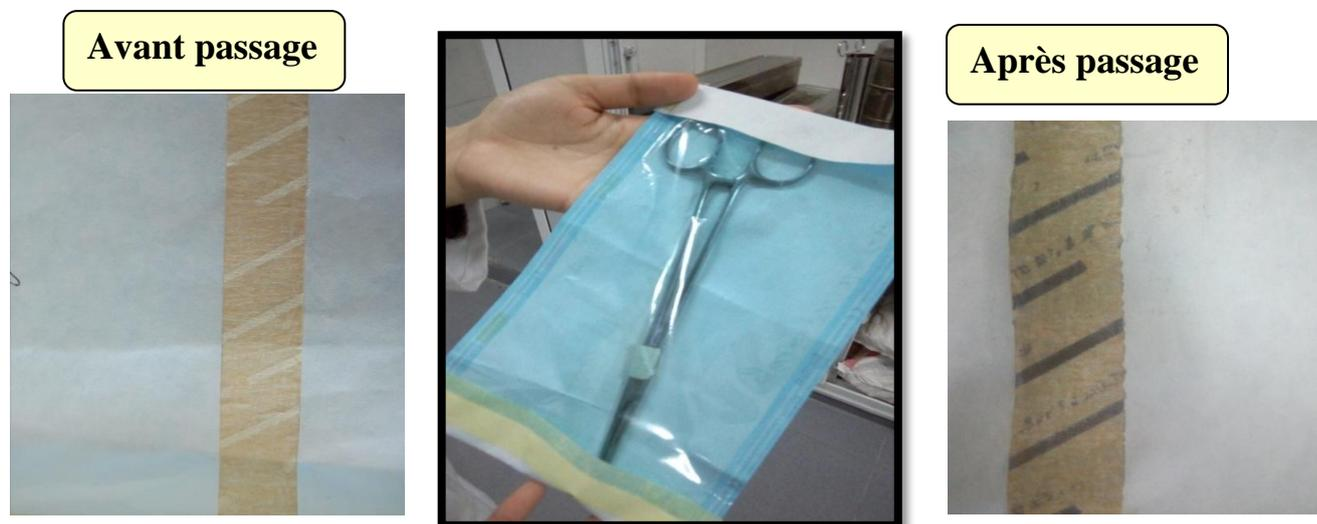
Figure IV-20 : Test de rubans d'indicateur
