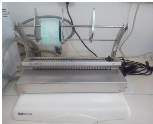
**Figure IV-14:** Appareil des gaines de stérilisation
