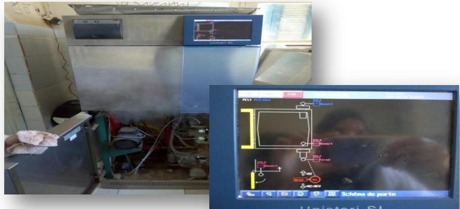
**Figure IV-28 :** Blocage de porte d'autoclave dans le service des urgences
