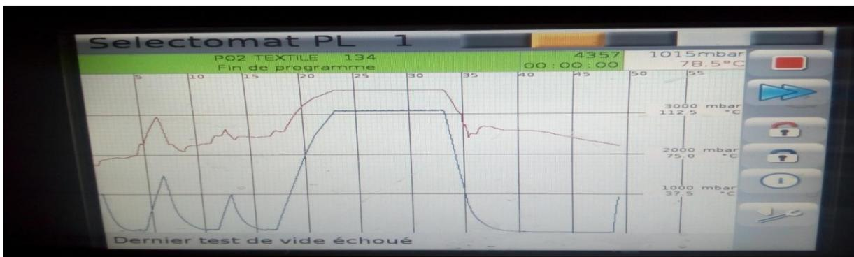
Figure IV-23 : Diagramme d'enregistrement cycle de stérilisation
