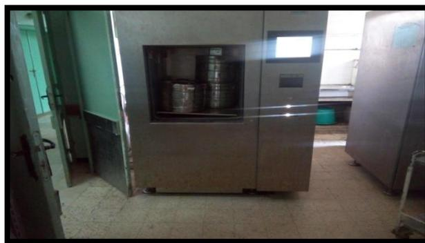
**Figure (II-3) :** Autoclave double ouverture au service de traumatologie (CHU Annaba)
