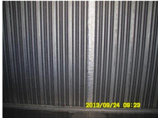
Fig. II.8 : Echangeur à plaques brasées
