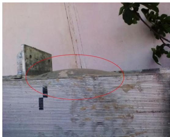
Fig. II.23 : Déformation de la tôle extérieure d'un échangeur de chaleur (type à plaques brasées- unité de liquéfaction du GN- GL1K)
