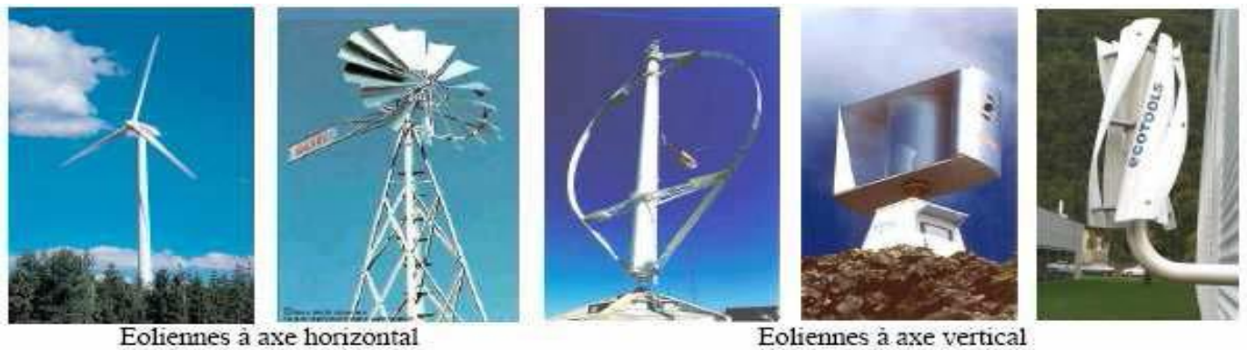
Figure I.6 : Différents types d'éolienne
