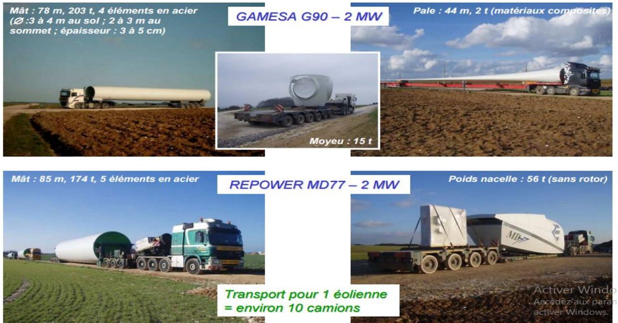
Figure. II.3 : transport des éléments de l'éolienne.
