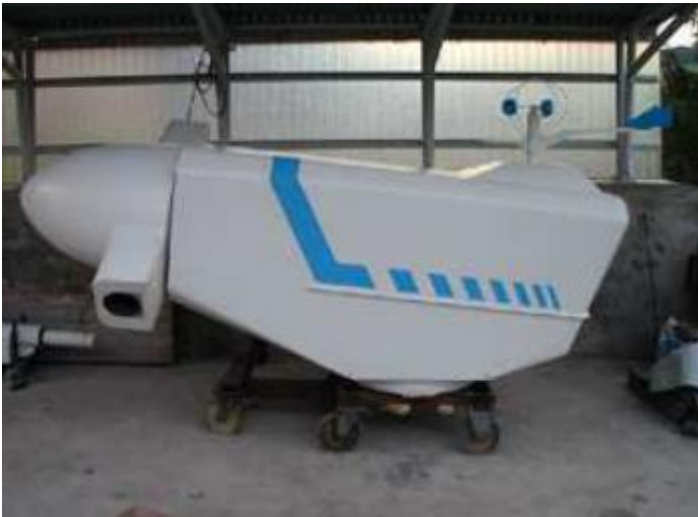
Figure II.8 : nacelle d'une moyenne éolienne
