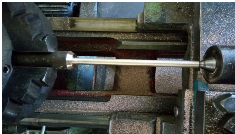
Figure II.2 Préparation de l'éprouvette de l'essai de traction.
