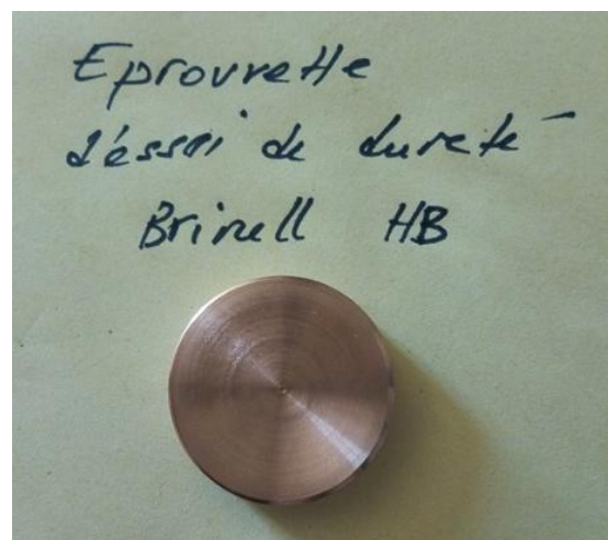
Figure II.8 Epreuve finie pour la dureté Brinell.
