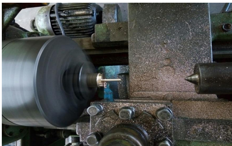
Figure II.5 Préparation l'éprouvette de cisaillement.
