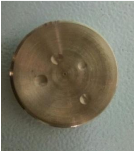
Figure II.21 Photo des empreintes obtenues durant l'essai Brinell.
