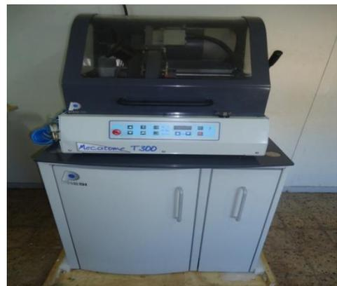
**Figure II.2** : Tronçonneuse MECATOME T300
