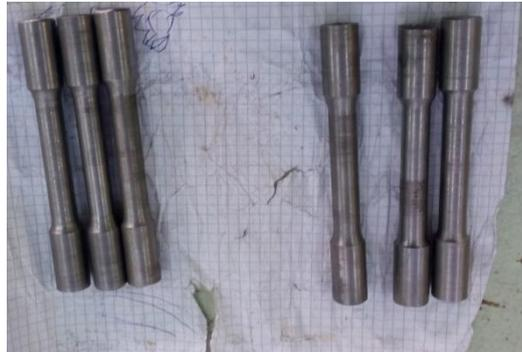
**Figure II.13** : Six éprouvettes usinées sur le tour
