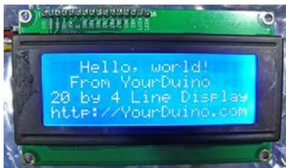
**Figure2.19 : afficheur LCD (4x20)**
