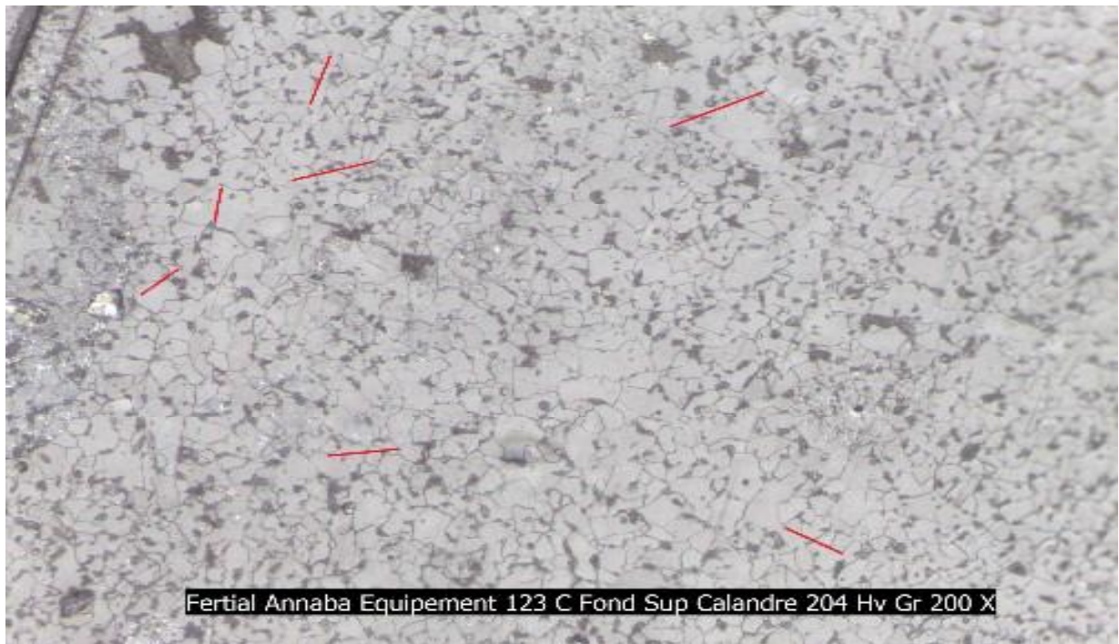
Fig2-16 :Contrôle par ressuage montre des fissures superficielles sur le fond supérieur de la calandre.[9]
