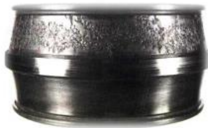
Figure 1.11 : Défaut de roulement – écaillage
