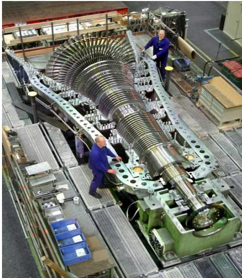
Figure II. 6 Turbine d'une centrale à vapeur de taille moyenne.
