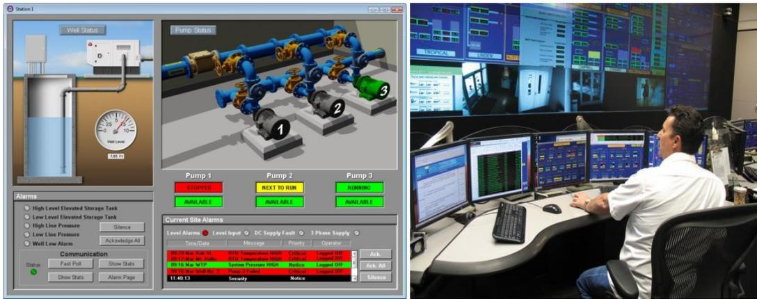
Figure 4: Interface Homme-machine Distribution d'eau potable
