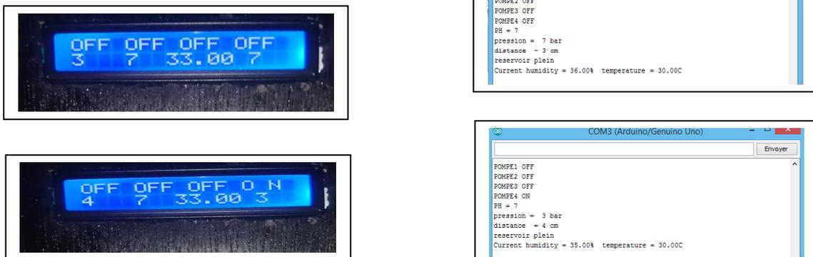
Figure 35: L'affichage de lecture de capteur pressionsur le pc et l'afficheur LCD
