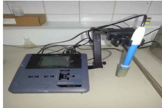
pH mètre de type Inolab pH 7110
