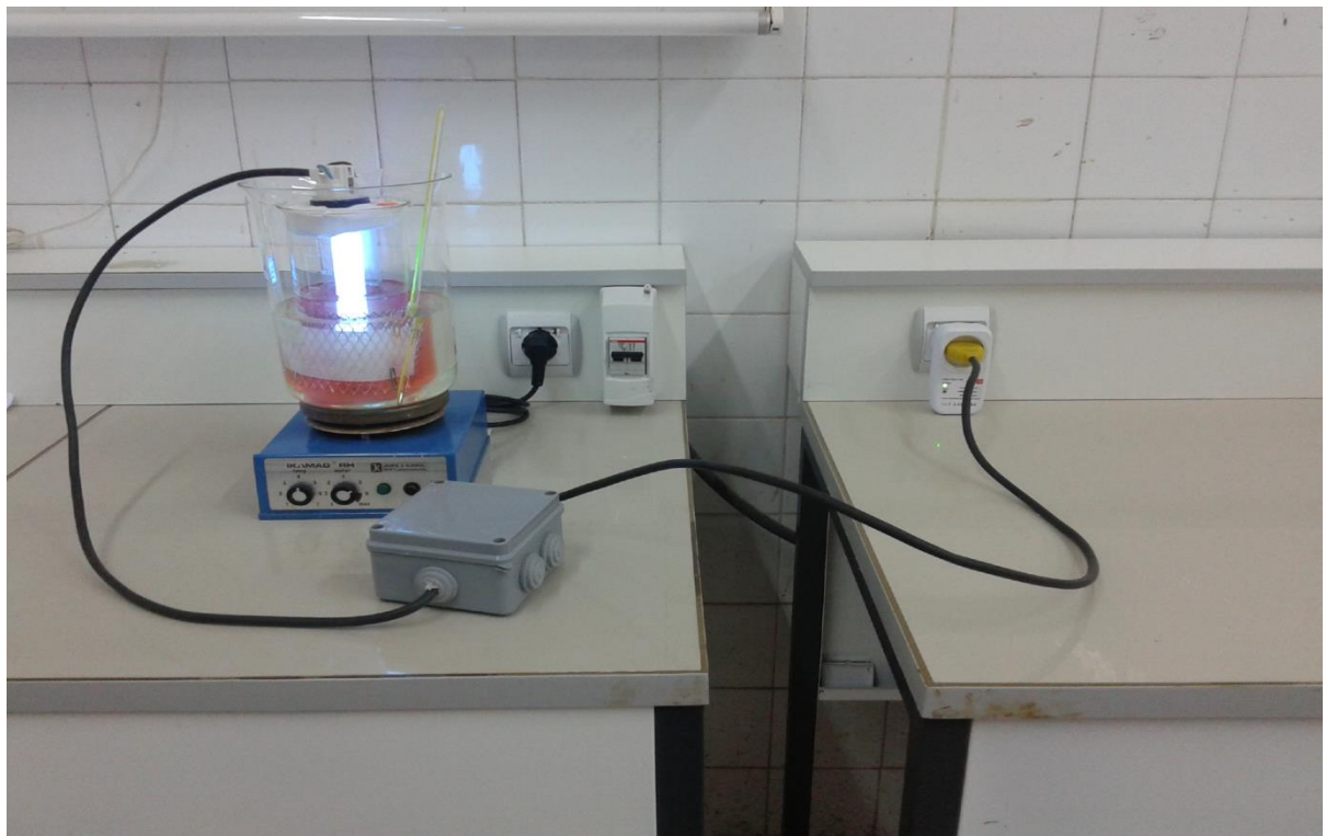
Figure A.1. Dispositif expérimental pour la dégradation du colorant Ecarlate Solophényl BNLE
