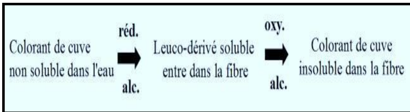
Figure I.4. Principe général de la teinture avec les colorants de cuve.
