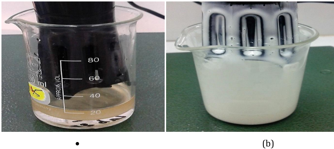
Figure III.4. Membrane liquide avant (a) et après (b) émulsification.
