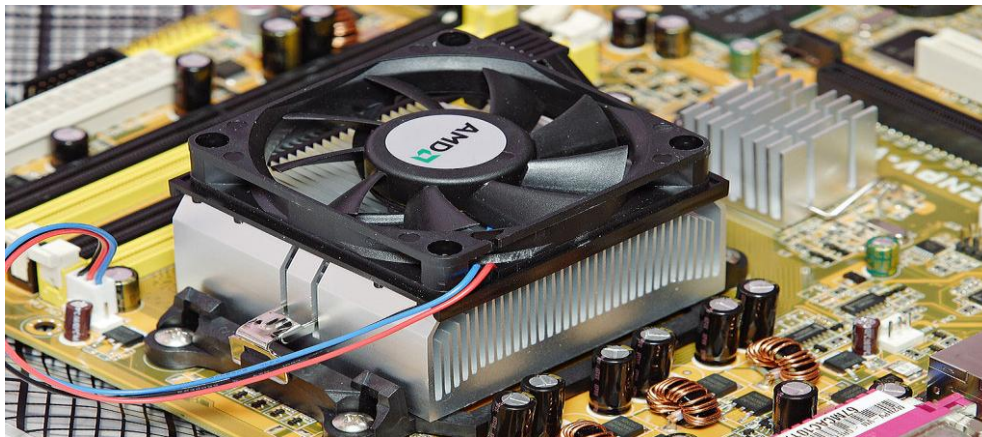
Figure I : Un dissipateur de chaleur refroidi par ventilateur sur le processeur d'un ordinateur personnel. À droite, un dissipateur de chaleur plus petit refroidit un autre circuit intégré de la carte mère
