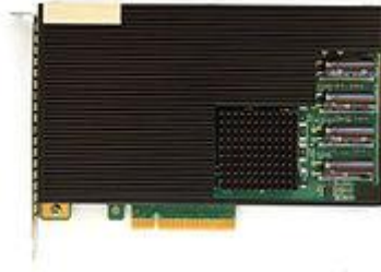
Figure I.3.10 : Une carte mémoire flash de niveau serveur avec un dissipateur de chaleur noir.
