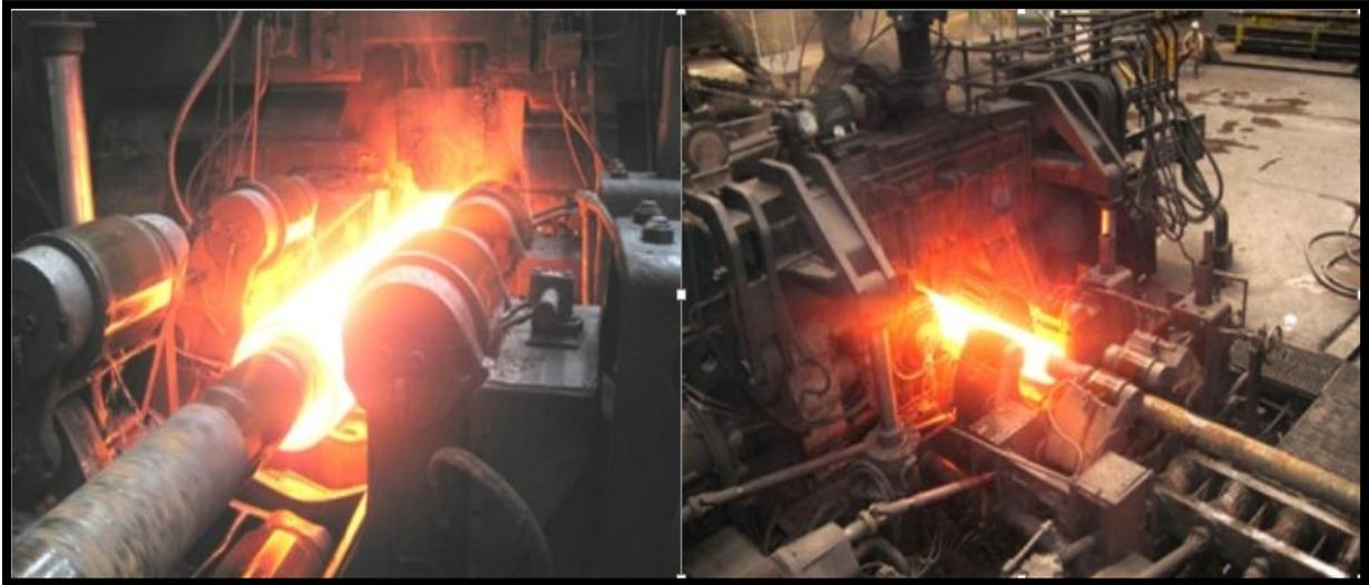
Dès que les cylindres saisissent le bloc creux, celui-ci est entraîné en rotation, et par suite de l'inclinaison des cylindres, il progresse dans l'axe du laminoir et vient rencontrer la tête de perçage.
