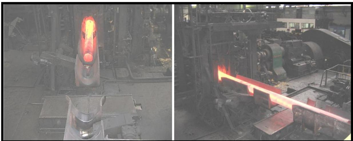
A la fin du laminage, le cylindre supérieur est soulevé par l'intermédiaire des vis de pression commandées par un moteur hydraulique. Ensuite on extrait le mandrin du tube à l'aide d'une guillotine située devant la cage, on évacue le mandrin de l'appareil, le tube est à son tour tiré par des rouleaux motorisés à la sortie de la cage à cylindres du laminoir pèlerin, et on affranchit les extrémités du tube à la scie à chaud.
