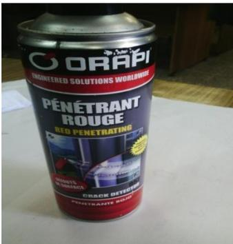
Le pénétrant s'introduit dans toutes les discontinuités ouvertes et débouchant en surface par capillarité. La durée d'imprégnation du pénétrant est comprise entre 5 et 60 minutes selon les normes, spécifications et codes applicables. Une durée de 20 minutes est souvent observée.
