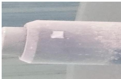
Figure IV-7 :application une réfléchissante sur l'arbre
