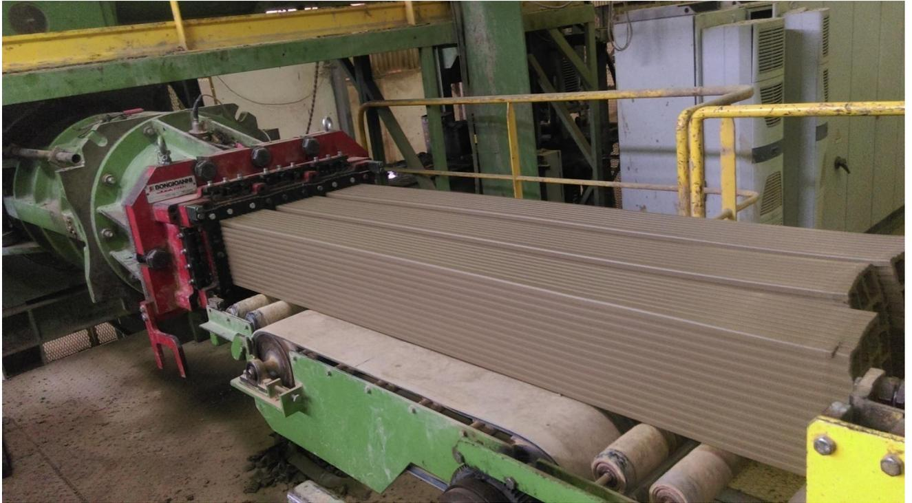
Figure I-16: Un boudin d'argile à la sortie de l'Etireuse
