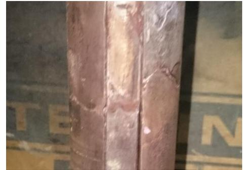
Figure IV-14 : L'arbre original B (Rupture)
