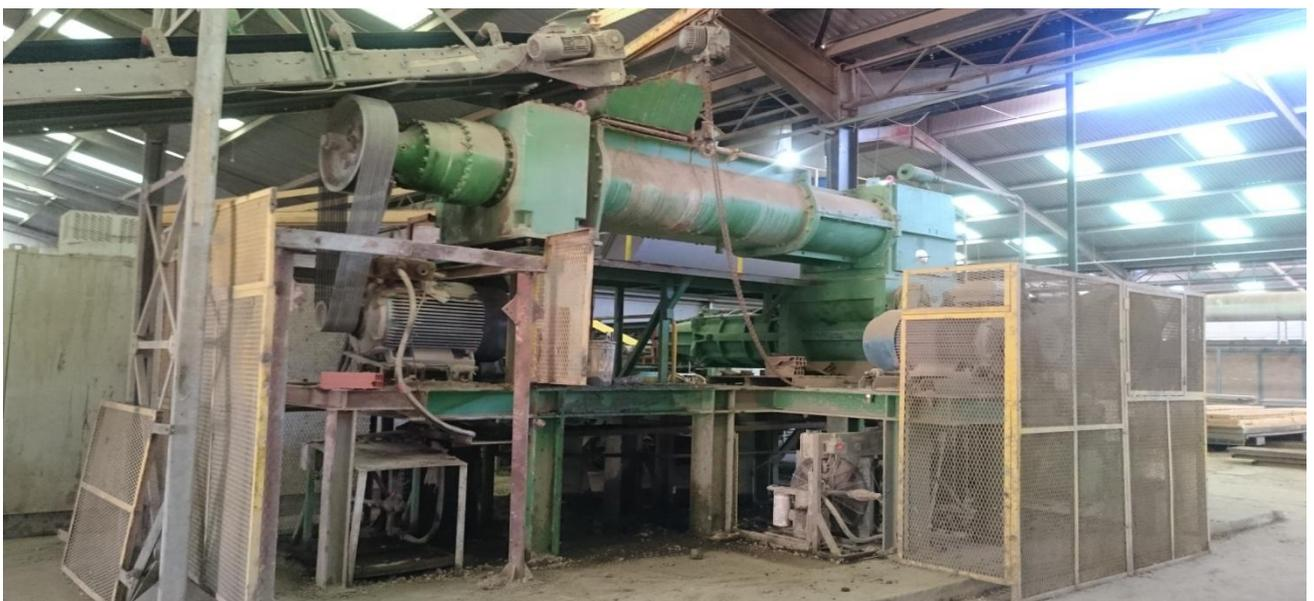
Figure I-15: Mouilleur mélangeur sous vide
