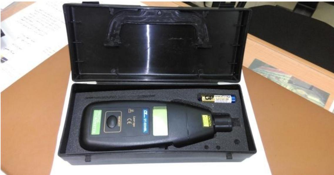
**Figure IV-3: Tachymètre DT-2234BL**
