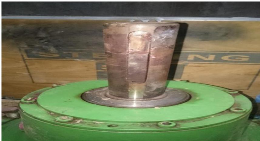
**Figure IV-2 : Vue général du l'arbre défaillant**
