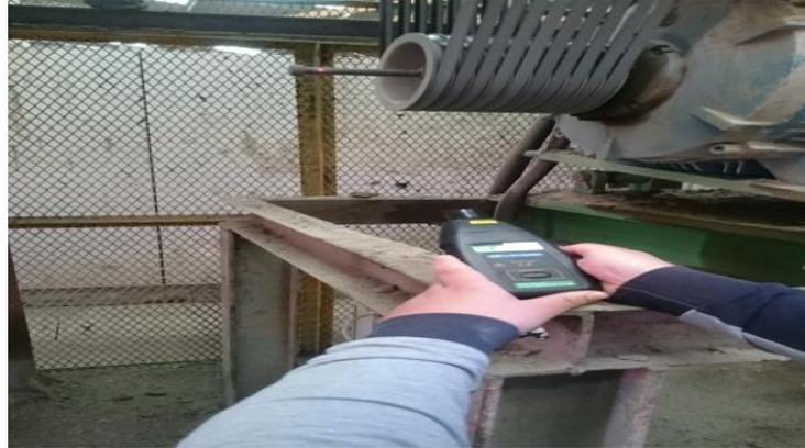
Figure IV-8 :application Du tachymètre
