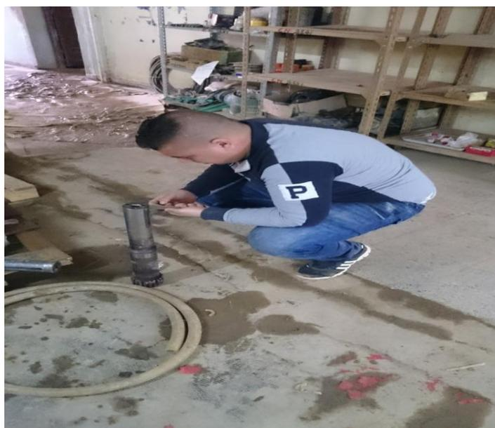
Figure IV-20 : Mesure ajustement de l'arbre avec pied a coulisse
