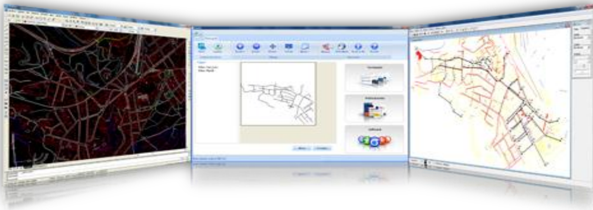
Figure IV.1 : Transformation d'un réseau en AutoCAD vers Epanet
