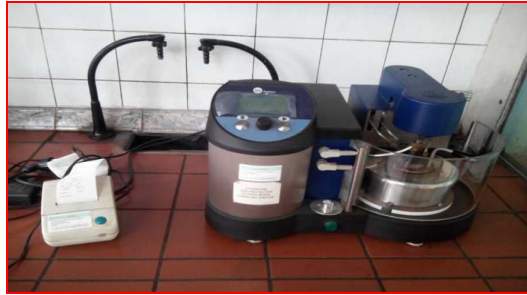
Figure V.11 : Dispositif pour la détermination du point d'éclair Seta MultiFlash.
