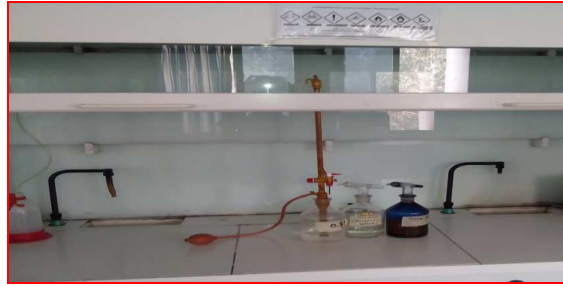
Figure V.12 : dispositif pour la détermination de l'indice d'acide.
