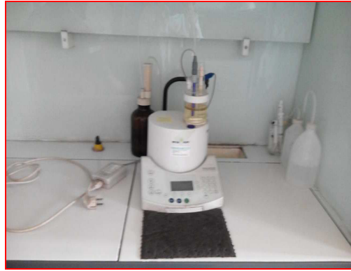
Figure V.10 : Dispositif Coulometer (mttler toled DL39) pour la détermination de la teneur en eau.
