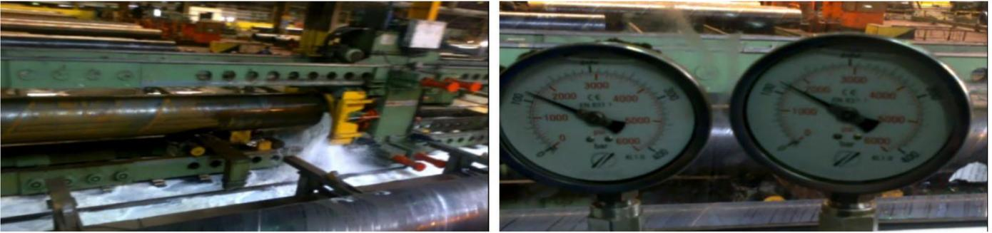
*Figure 3.2.1.C. Contrôle hydrostatique*
