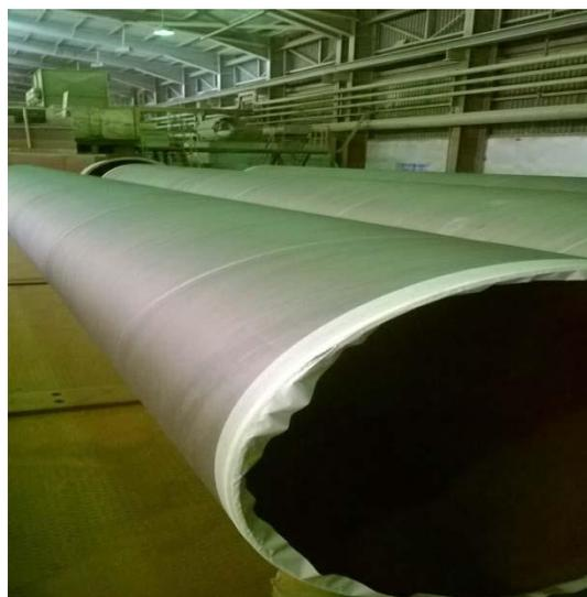
**Figure II.6. Le tube après le grenailage**
