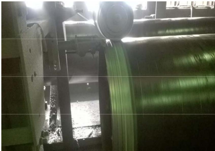
**Figure II.10. Elimination de l'eau, nettoyage des extrémités des tubes .**
