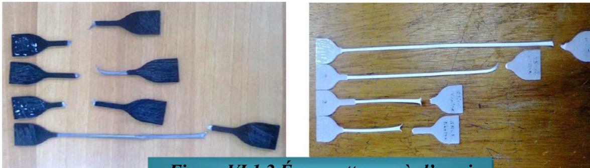
*Figure VI.1.2 Éprouvettes après l'essai*
