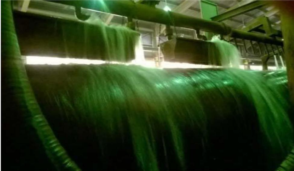
**Figure II.9. Refroidissement par eau**
