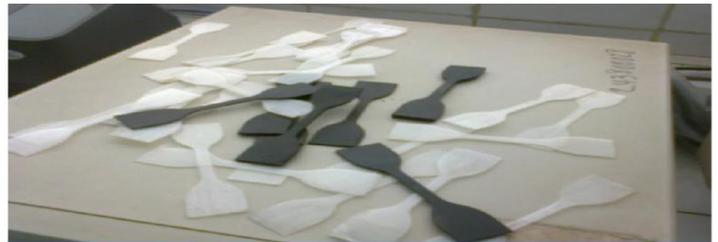
*Figure 3.2.5.B. Eprouvette de traction*
