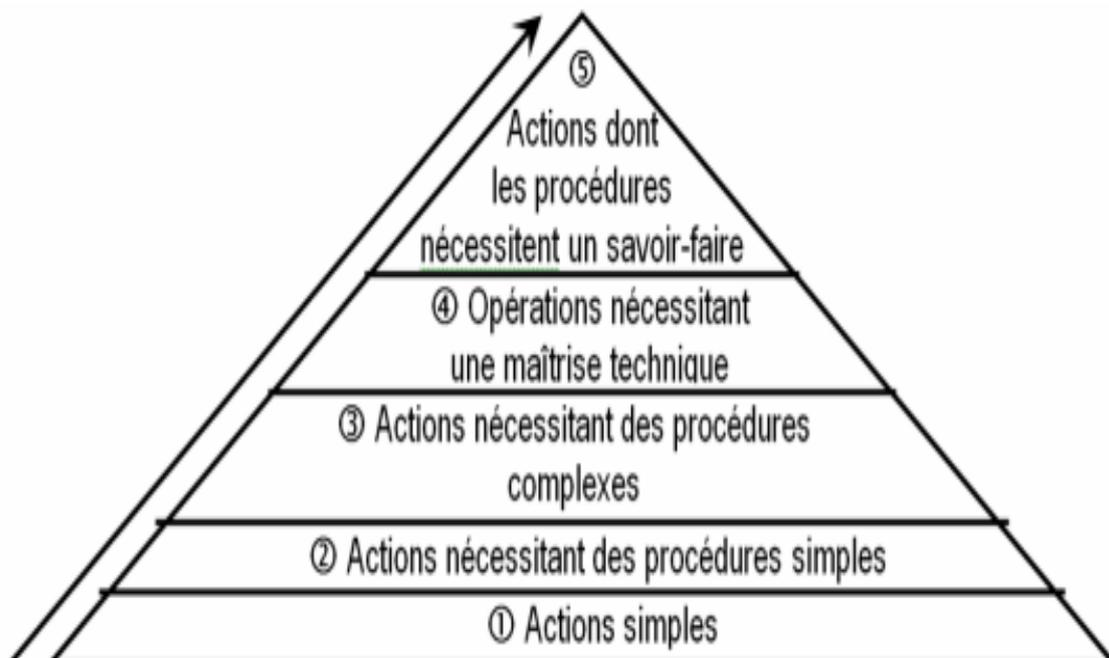
**Figure 4** : les Tâches de la Maintenance [1]
