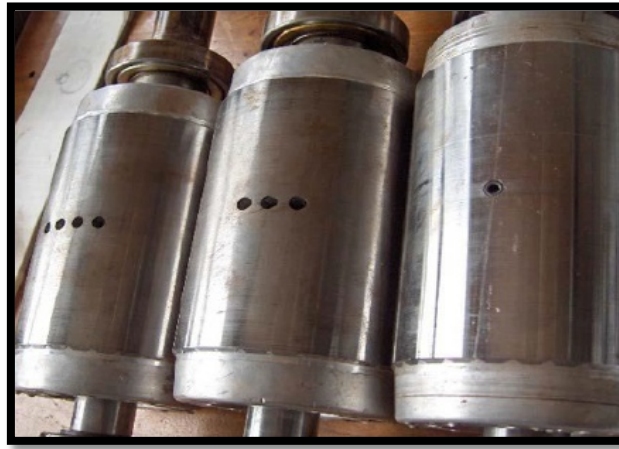
Figure.1.8. Rupture de barre [8]
