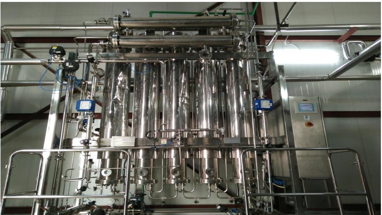
**Figure 14** - Distillateur à effets multiples
