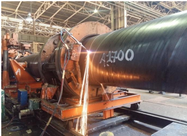
Figure I.11: oxycoupage par chalumeur
