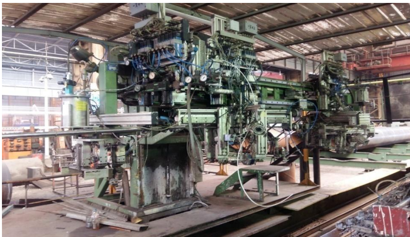
Figure I.6 : machine de contrôle ultrason automatique
