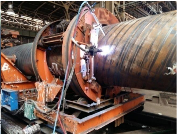
Figure I.12: oxycoupage par plasma
