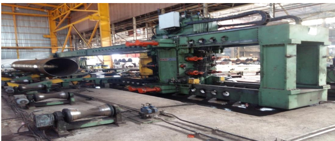
FigureI.4 : La machine d'essais hydrostatique
