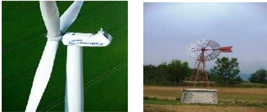
**Figure I- 5** Eoliennes tripales et multi-pales [11].
