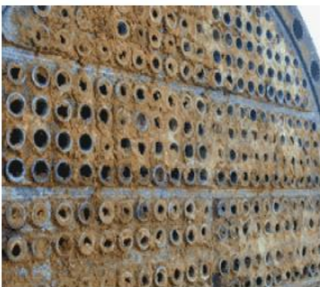
Fig. II.22 : Echangeur propre (à droite) et échangeur sale (à gauche)
