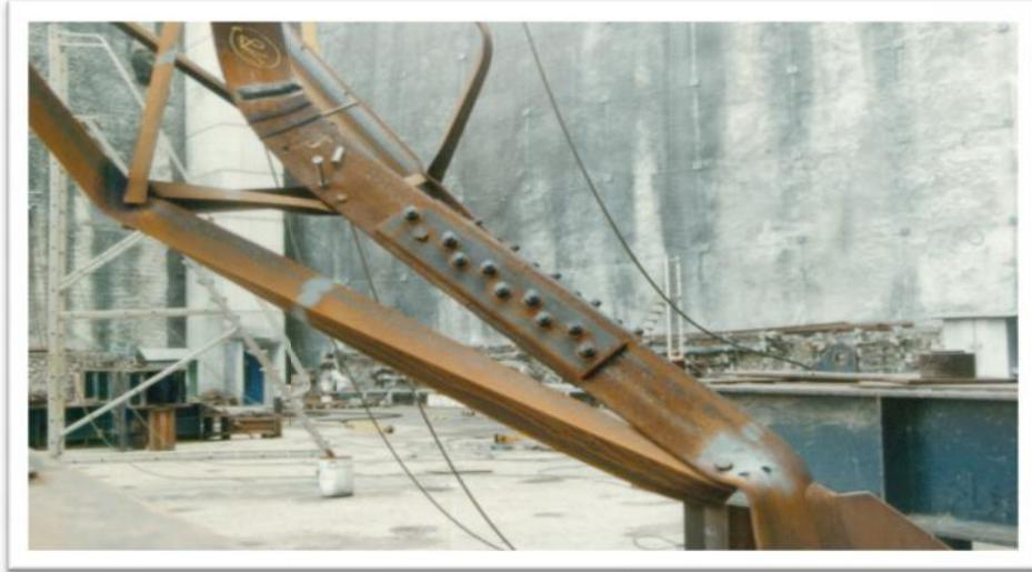
**Fig. 14 :II-3 : Vue de la rupture de pylône**
