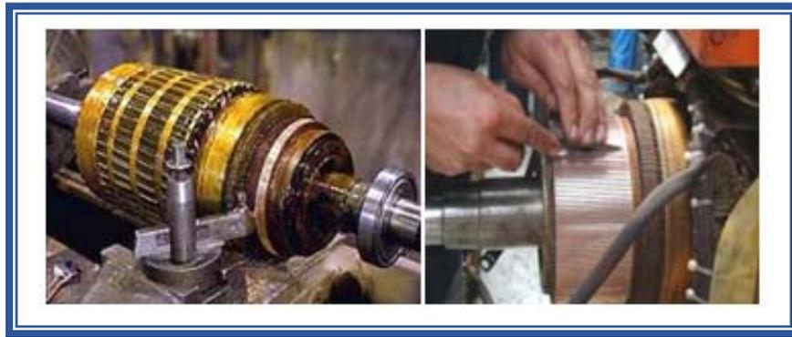
**Figure I.3.** Composition de l'induit
