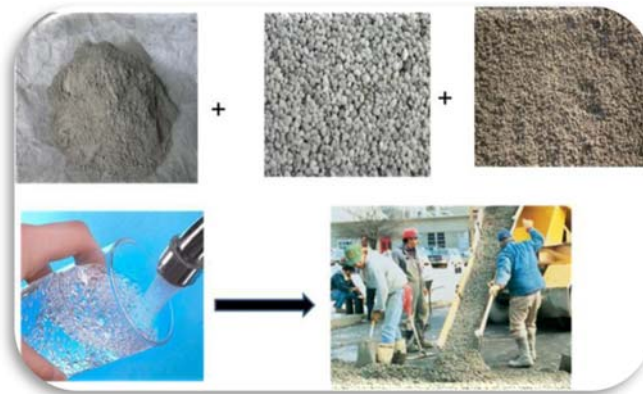
Figure1 : les composants du béton
