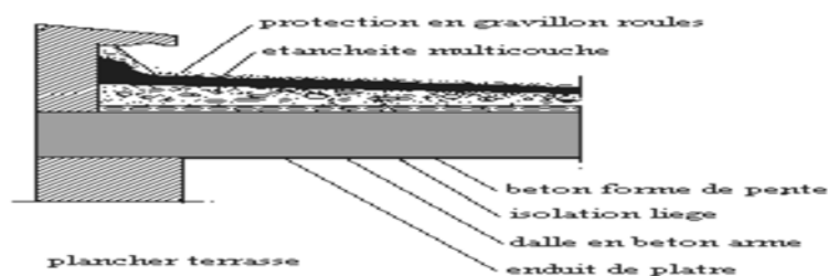
Figure 12 :couches du plancher terrasse
