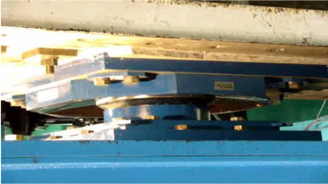
Figure II-c-3 : isolateur de type pendule inverse – construction réalisée sur chantier
